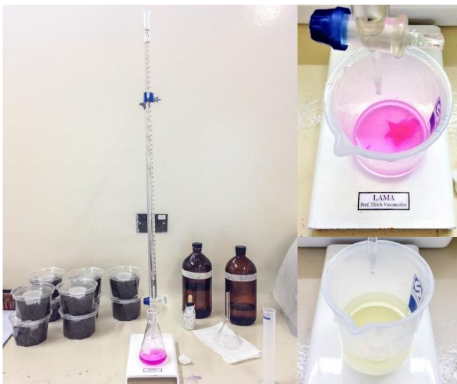
Figura 4 – Técnica de titulação para o ensaio de respiração microbiana.
