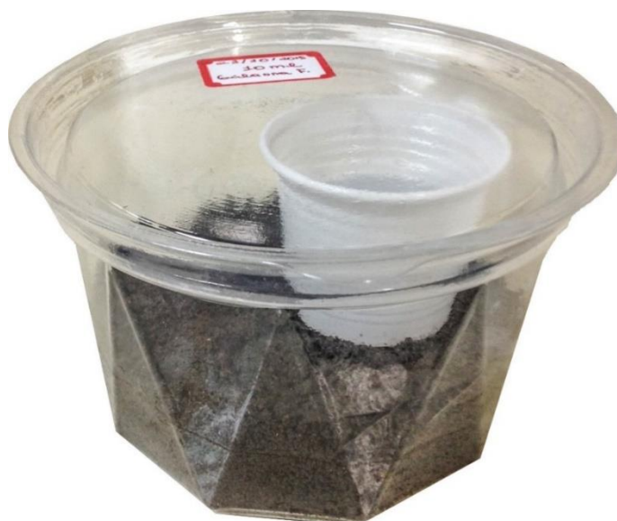
Figura 3 - Reator de polietileno para o ensaio de biodegradação.
