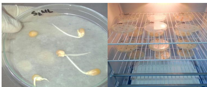
Figura 5 - Estufa e Placa de Petri com sementes e papel filtro embebido pela solução do solo.
